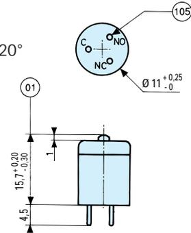
Wires: 0.38 mm<sup>2</sup> Air 4524 - length 0.50 m.
