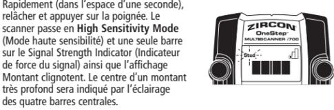
Rapidement (dans l’espace d’une seconde), relâcher et appuyer sur la poignée. Le scanner passe en **High Sensitivity Mode** (Mode haute sensibilité) et une seule barre sur le Signal Strength Indicator (Indicateur de force du signal) ainsi que l’affichage Montant clignotent. Le centre d’un montant très profond sera indiqué par l’éclairage des quatre barres centrales.
