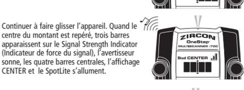
Continuer à faire glisser l’appareil. Quand le centre du montant est repéré, trois barres apparaissent sur le Signal Strength Indicator (Indicateur de force du signal), l’avertisseur sonne, les quatre barres centrales, l’affichage CENTER et le SpotLite s’allument.
