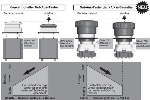
Bei den Geräten der XA/XW-Baureihe ist das Energieniveau der Öffnerkontakte im Betriebszustand (geschlossen) höher als im betätigten Zustand (offen). Sollte der Kontaktblock durch einen übermäßigen Stoß abfallen, tendieren die Öffnerkontakte zum Öffnen. Damit wird für einen sicheren Zustand gesorgt und die Maschine gestoppt.
