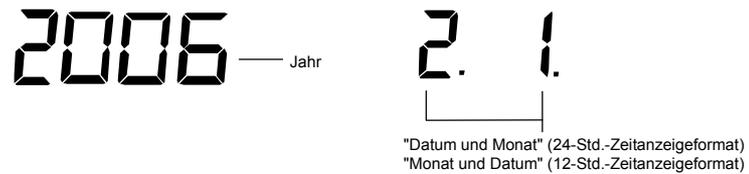
Die Kalendervoreinstellung der Temperaturstation nach der Grundeinstellung ist der 1.1. des Jahres 2006. Wird das funkgesteuerte DCF-77-Zeitsignal empfangen, wird damit automatisch auch das Kalenderdatum auf den neuesten Stand gebracht. Ist kein DCF-Signalempfang möglich, so kann das Datum auf folgende Weise auch manuell eingestellt werden:
