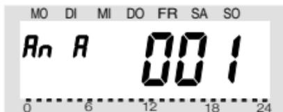
Es folgt das Synchronisieren des (ersten) Ventilantriebes („001“ im Display) auf den neuen Sicherheitscode. Folgende Schritte wiederholen sich beim Einsatz mehrerer Ventilantriebe.
