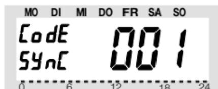
Es folgt das Synchronisieren des (ersten) Ventiltriebes („001“ im Display) auf den neuen Gerätecode.
