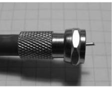
1. Koaxialkabel abisolieren: ca. 15 mm vom Mittelleiter und 7 mm vom Mantel.
