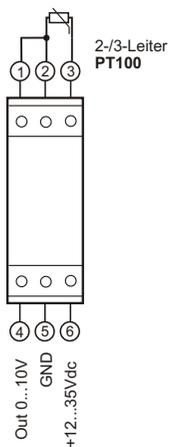
Die Ausgangsspannung folgt linear dem am Eingang anliegenden Temperatursignal. Zwischen dem Sensor und der Versorgungs- bzw. Ausgangsspannung darf keine galvanische Verbindung bestehen.
