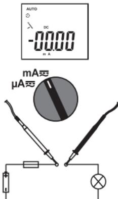
**Voor het meten van wisselstroom gaat u als volgt te werk:**
