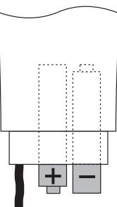
Il est nécessaire de remplacer les piles lorsque le témoin jaune (E) ne s'allume plus et que le signal sonore n'est plus émis en reliant les deux pointes de sonde (1 et 11) ensemble.
