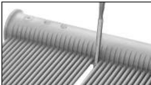
**6.2** Sprühen Sie den Gummieinsatz und den PVC-Pin mit Silikonspray ein.
