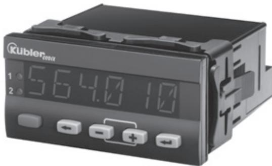
Das Temperatur-Steuergerät Codix 564 zeigt in hoher Auflösung Temperaturwerte an und überwacht und regelt 2 Grenzwerte. Alle gängigen Temperatursensoren, wie die Thermoelemente B, E, J, K, N, R, S und T sowie mV-Eingänge, Pt100 und Widerstandseingänge, können an das Gerät angeschlossen werden.
