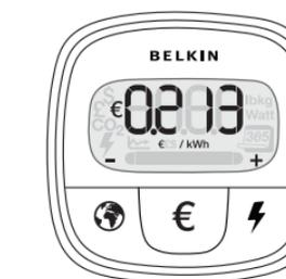
Wenn Sie die Euro-Taste mindestens 3 Sekunden lang gedrückt halten, wird der Tarif auf die Werkseinstellung zurückgesetzt.
