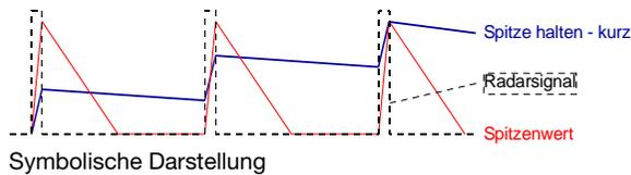
Der Gleichgewichtswert kann je nach Radartyp bis zu 10 dB, also einem Faktor 10 unter dem tatsächlichen Ist-Wert der Leistungsflussdichte liegen, bei bestimmten Radartypen sogar noch darüber. Aus diesem Grunde sollte man gemessene Radarsignale (= Gesamtpegel abzüglich der Hintergrundstrahlung, d.h. dem Messwert zwischen den Pulsen) mit einem Faktor 10 multiplizieren und dann erst den Vergleich mit den Grenz- und Richtwerten durchführen.
