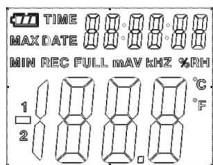
1. Dit batterijpictogram wordt getoond als de batterij volledig is geladen. Als de batterij leeg is, wordt dit pictogram weergegeven. Op dat moment is vervangen van de batterij noodzakelijk.
